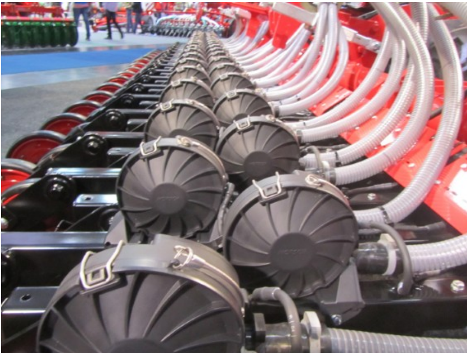
Billede 3. Enheden reducerer forskellen på afstanden mellem planterne. Foto: Henning Sjørlev
